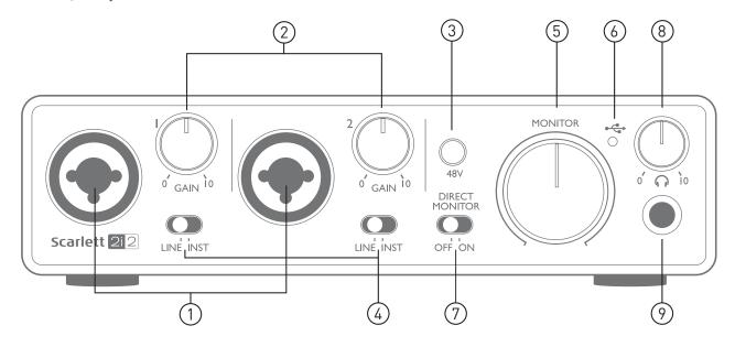
フロントパネルには、Mic、Lineおよびインストゥルメント信号、入力ゲイン、モニタリングコントロールが備わっています。
