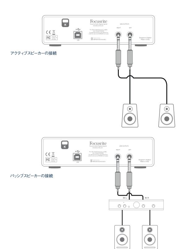
ライン出力は 3 極(TRS)%インチ(6.35mm)ジャックソケットであり、バランス出力です。一般的な家庭用(Hi-Fi)アンプと小型パワードモニターには、フォノ(RCA)ソケットまたはコンピュータに直接接続するための 3.5mm 3 極ジャックプラグ経由のいずれかにアンバランス入力が備わっています。いずれの場合も、一端にジャックプラグの付いた適切な接続ケーブルを使用します。
